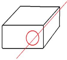
Es wird aus der Mitte gebohrt so das genügend Platz/Material bleibt für den Daumenschutz. Die Größe der Bohrung wird durch die schmale Seite des Daumengelenks, also **quer zum Fingernagel**, bestimmt. Bei mir waren es 20mm, gebohrt habe ich mit 18mm, um mir noch Material zu lassen für die Feinanpassung.
