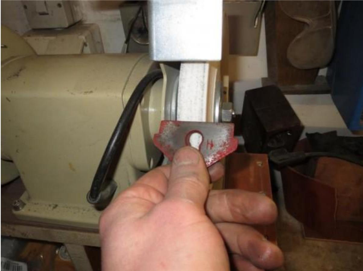
Passgenauigkeit/ Planheit prüfen...Grobe Schleifspuren ausschleifen/ auspolieren...
