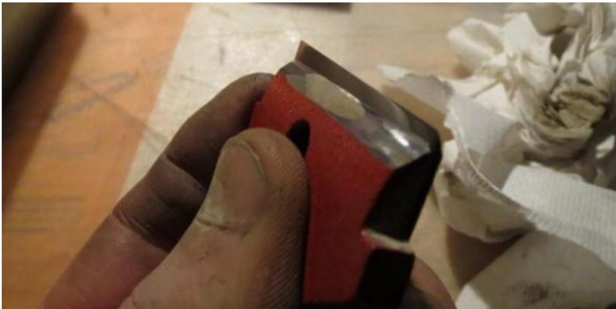
Wenn das zu einem ausreichendem und befriedigenden Maß getan ist, wird die Decke in den Schraubstock gespannt und es wird nach gängiger Methode ein Grat angezogen - wie bei einer Ziehklinge. Dieser Grat hat die Funktion, so gut wie möglich, den minimalen Spalt zwischen Decke und Eisen abzuschließen, damit die Späne schön aus dem Maul kommen. Dazu trägt auch die neue Form der Kante bei.
