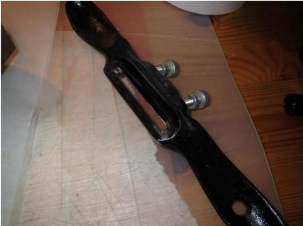
Um erstmal zu schauen was Sache ist, wird zuerst über eine feine Körnung geschliffen - nochmal: wer keine Diamantsteine, Wassersteine oder was auch immer hat - Glasscheibe oder Granitplatte und Nassschleifpapier gehen ebenfalls hervorragend.
