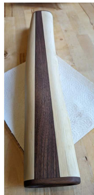
Dann bin ich nochmal bis 400er Körnung drüber gegangen und habe den Köcher mit Leinölfirnis geölt
