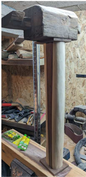
Zwei Stücke Nussbaum ganz Grob zugeschnitten, alle Klebeflächen mit Aceton gereinigt und mit Epoxi verklebt
