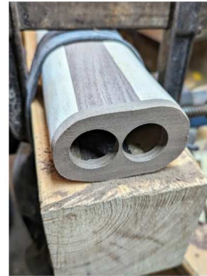
Oben mit einem Forstnerbohrer zwei Löcher rein
