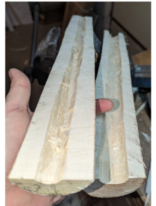
Mit einem Hohlbeitel schon mal etwas rausgearbeitet
