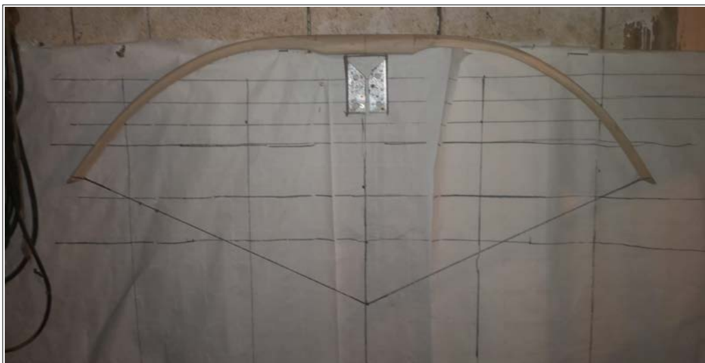
Abbildung 2: Zu sehen ist ein Langbogen mit einem Auszug von 28 Zoll. Mit dieser Vorrichtung, dem Tillerbrett, wird überprüft ob der Bogen bei beiden Wurfarmen die gleiche Krümmung hat.
