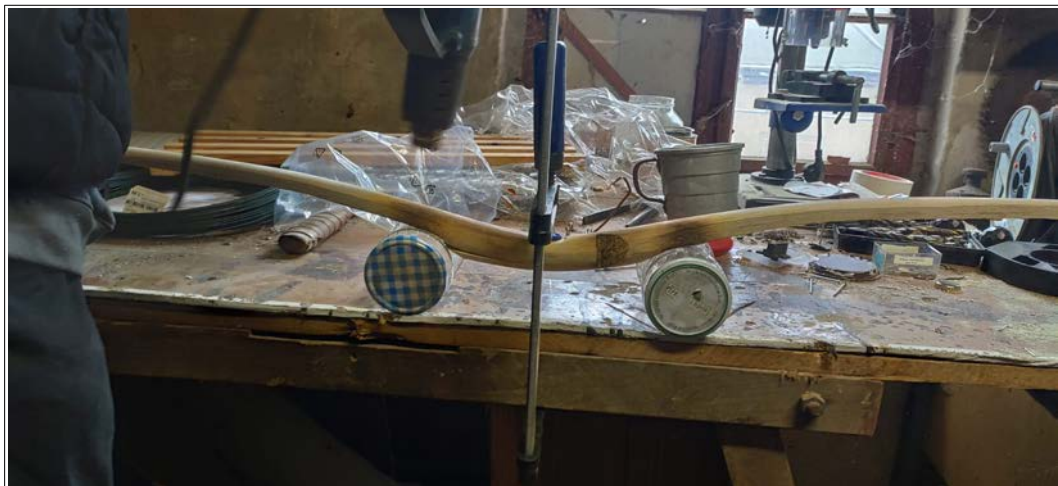
Abbildung 4: Im Bild erkennbar ist das Erhitzen und Biegen der Wurfarme, das Entstehen der gebogenen Fadeouts.
