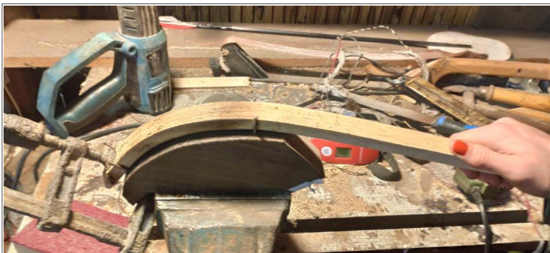
Abbildung 3: Mithilfe einer Heißluftpistole werden die Tips des Bogens entgegengesetzt zur Biegung der Wurfarme erhitzt und umgebogen, wodurch die sogenannten Recurves entstehen.
