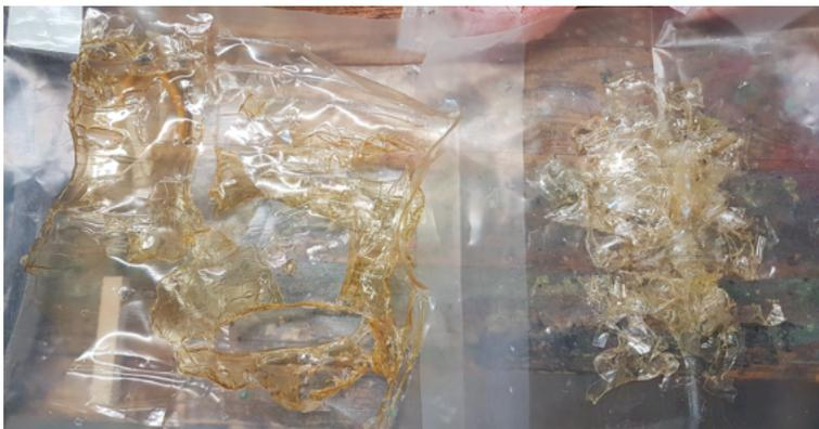
Leim getrocknet und teilweise zerkleinert. rechts erster Abguss.
