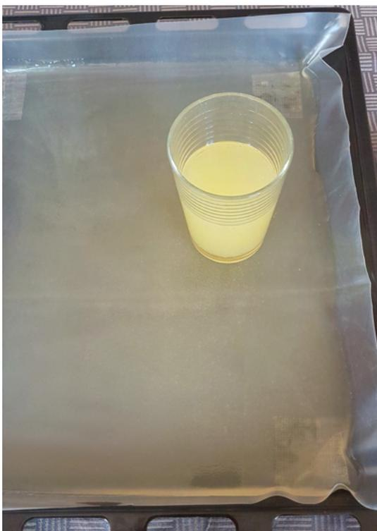
Leimlösung geliert (das Trinkglas dient nur zur Verdeutlichung, dass der Leim geliert ist). Die Leimlösung geliert relativ langsam und ist zunächst auch bei Zimmertemperatur noch flüssig. Ich habe den Vorgang im Kühlschrank beschleunigt.
