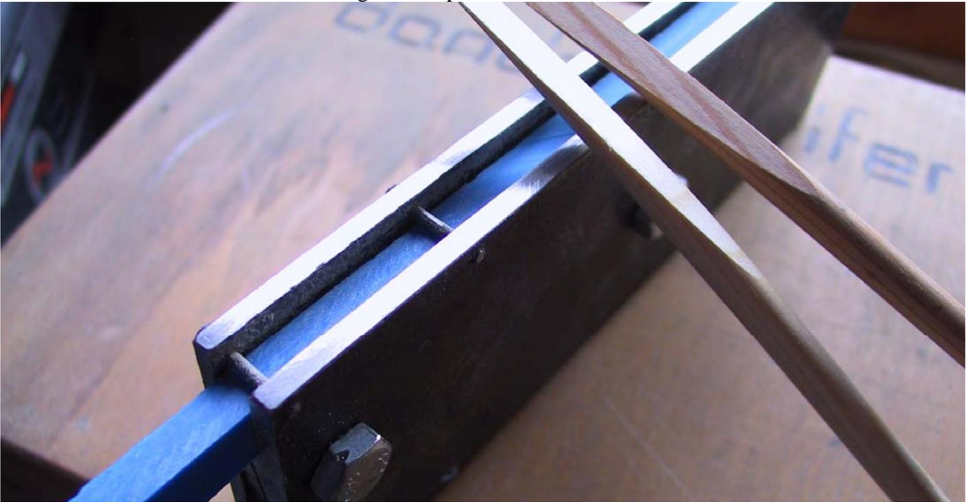
Der Rest ist einfach. Spleißfläche mit Kleber (wasserfester Holzleim reicht) einstreichen, aufeinanderlegen und fixieren. Ich verwende die Bindemethode, da sich dabei die Schaftteile von selbst ausrichten. Man kann aber auch Wäscheklammern verwenden oder die Schaftteile in einen kleinen Aluwinkel einlegen und mit Leimklammern fixieren.
