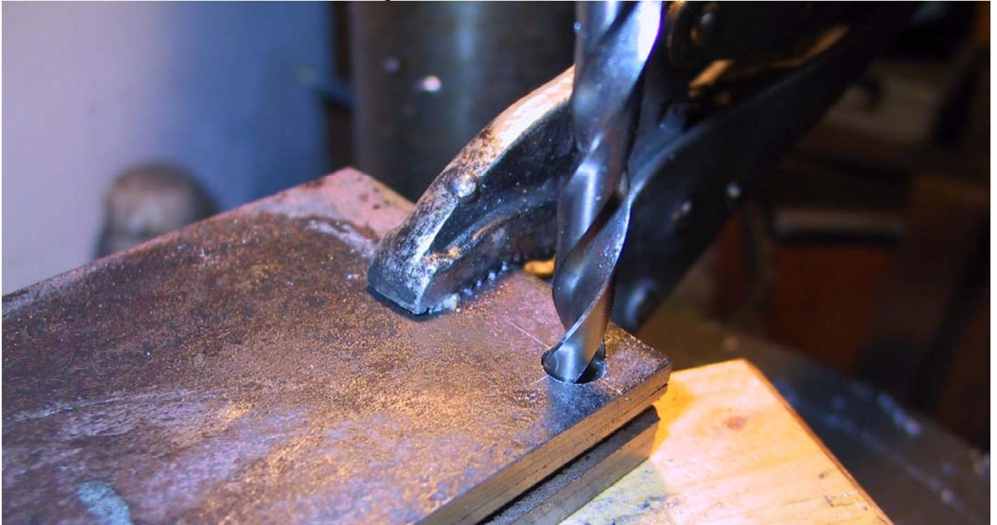
Dann wird sofort durch dieses 8mm Loch eine M8-Schraube gesteckt und leicht festgezogen. Jetzt werden die 2mm Stifte herausgezogen, die beiden mittleren Bleche herausgeschwenkt und durch das einzelne, untere 2mm Loch wieder einer der Stifte gesteckt. Die beiden äußeren Bleche müssen jetzt gegen diesen Stift gedreht werden, sodaß sie dort fest anliegen. Durch die äußeren Bleche werden die beiden anderen Stifte gesteckt und das ganze wieder mit einer Gripzange fixiert.
