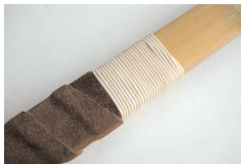
Bild 59: Zum Schluss wird aus Rattan der Arrowpass gewickelt und mit Leim fixiert.
