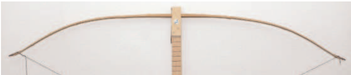
Bild 45: Standhöhe. Eine Überprüfung mit einem Bildbearbeitungsprogramm ergibt, dass die Wurfarme nun gut übereinstimmen. Zeit für die endgültige Sehne. Gewicht: 410 Gramm.
