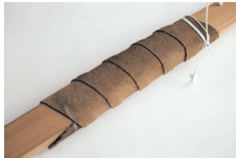
Bild 57: Die Griffwicklung wird mit Schneiderkreide markiert.
