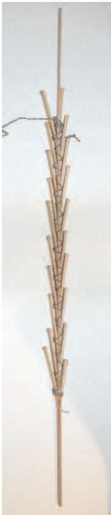
Bild 11 Frisch verleimte und gekeilte Mittellage
