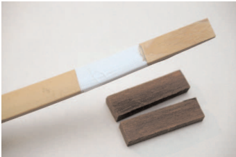
Bild 30: Die Enden und Klötzchen aus Bongossi sind für das Leimen vorbereitet.
