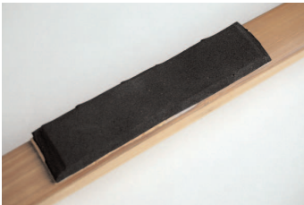
Bild 56: Darauf wird fünf mm starkes Moosgummi aufgeklebt.
