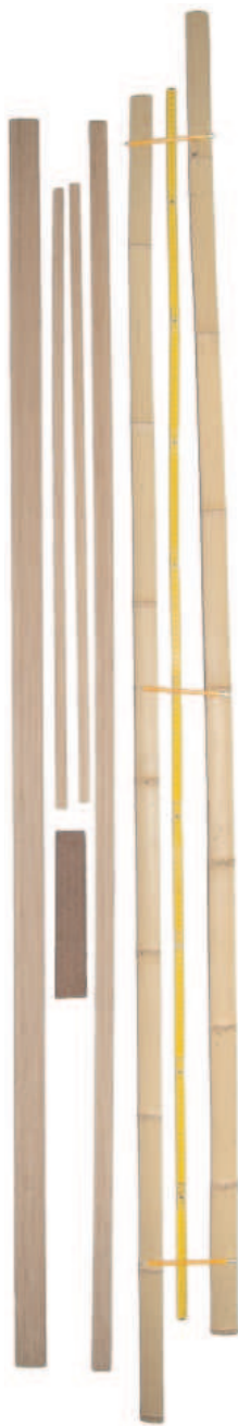
Bild 3: Material von links nach rechts - Actionboo im Lieferzustand 50 mm breit, 5 mm dick - Actionboo für die Mittenaufdopplung - Hartholz für die Tips - Actionboo 32 mm breit - Bambus für die Rückenlage - Bambus für die Bauchlage Die Bleistifte zeigen die Mitte, Tips und die Positionen der Nodien beim geplanten Bogen.
