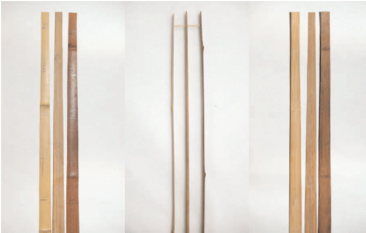
Bild 21: Fertig gehobelte Leisten. Außen, Seite und Innen. Beachte die Beschriftung
