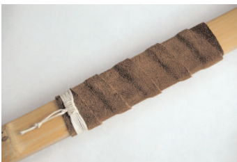
Bild 58: Die Griffwicklung wird beschnitten und mit Schusterleinen fixiert.
