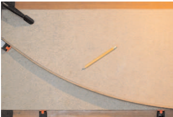
Bild 22: Zeichnen des Reflexes für die Lehre. Die Mittellage wird als Kurvenlineal verwendet.
