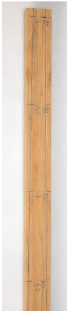
Bild 13 Zielmaße der Mittellage. Nur ein Wurfarm dargestellt. Maße in mm
