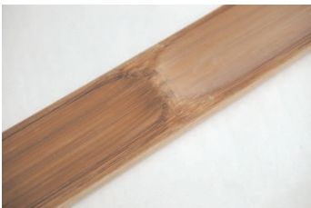
Bild 47: Der Tiller erfolgt durch Materialwegnahme am Bauch des Bogens.
