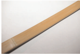
Bild 42: Während des Tillerns werden Rücken und Bauch gleichmäßig abgezogen
