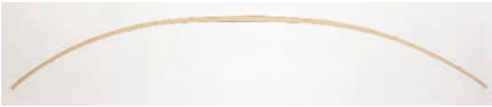
Bild 29: Der Rohling ist getrocknet. Die Kanten sind bereits versäubert und abgerundet.
