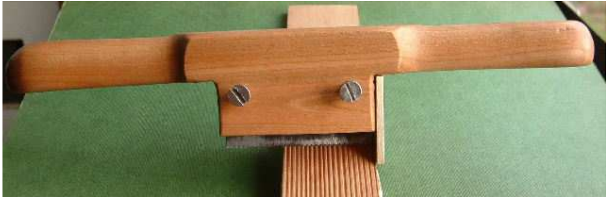
Abb. 1: Zahnhobel in Funktion
