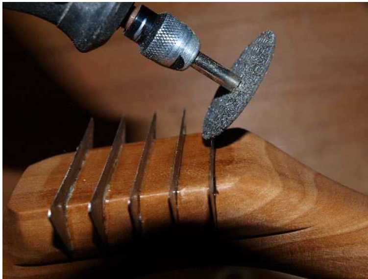
Abb. 15: Klingen scharf schleifen mit Dremel-Flex
