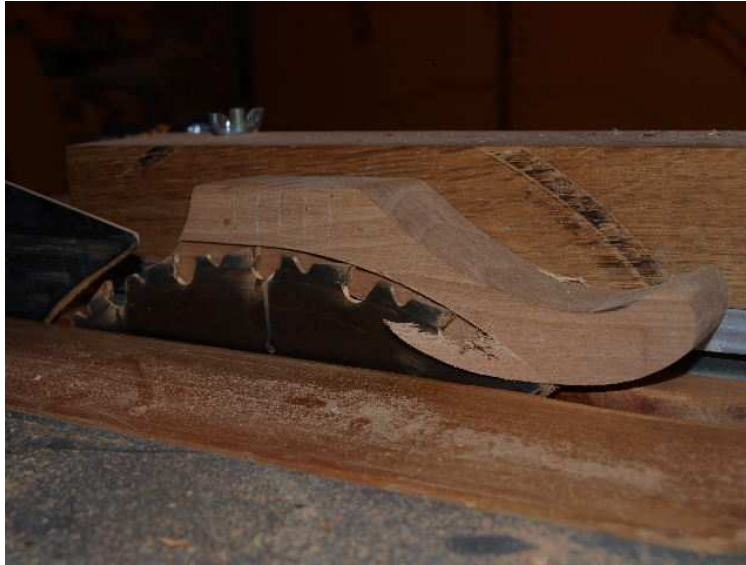
Abb. 8: Absatz sägen mittels Kreissäge
