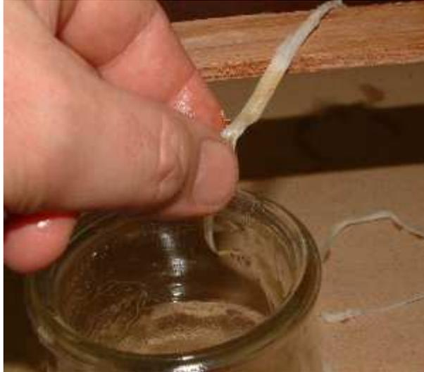
Auf der Mittellinie am Griff beginnend werden nun Sehnenbündel neben Sehnenbündel in Richtung der beiden Seitenkanten parallel zur Mittellinie aufgetragen und mit einem nassen Finger glatt gestrichen.
