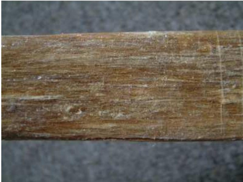
Um ein gleichmäßiges, 3 mm dickes Sehnenbacking (ideale Gesamtschichtdicke) zu bekommen, ist eine zweite Schicht notwendig. Man verfährt wie bei der ersten Schichtung: Leim aufpinseln und leicht erwärmen, um die erste Schicht anzulösen; Bündel für Bündel auftragen und dabei gleichzeitig die Senken und Erhebungen der ersten Schicht ausgleichen.
