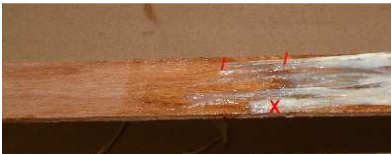
Wenn der ganze Bogenrücken bzw. der zu belegende Teil mit Sehnen bedeckt ist, wird die ganze Schicht mit dem Fön leicht erwärmt und mit einem nassen Finger unter starkem Druck gleichmäßig flachgedrückt. Feuchter Leim ist ein guter Nährboden für Schimmelpilze. Einfrieren verhindert, dass der Leim schimmelt, verschlechtert jedoch die Qualität; daher ist es besser, jedes Mal neuen Leim aufzubereiten.
